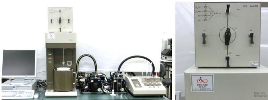
本事業により導入した「自動比表面積・細孔分布測定装置」
